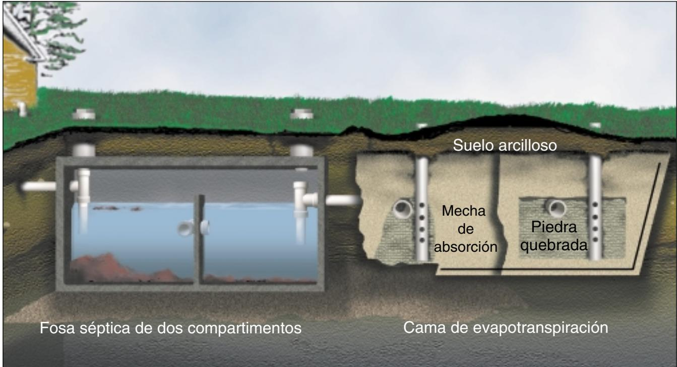
Figure 1: Un sistema de lecho de evapotranspiración.
