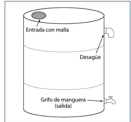
Figura 2. Diagrama de los componentes de un barril de lluvia.
