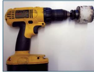
Figura 8. Taladro y sierra de perforación de 2  $\frac{3}{8}$  pulg.
