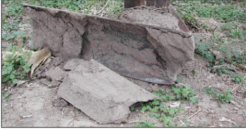
Figura 1. Zanjeador utilizado para hacer la base para instalar el politubo.
