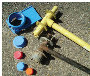
Figura 6. Perforador y tapones utilizados con el politubo.
